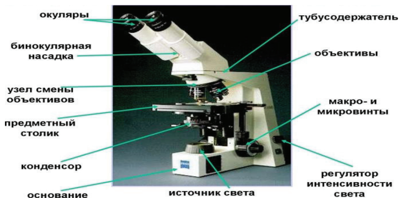
Рис. 15 Строение микроскопа (intergen.ru)
